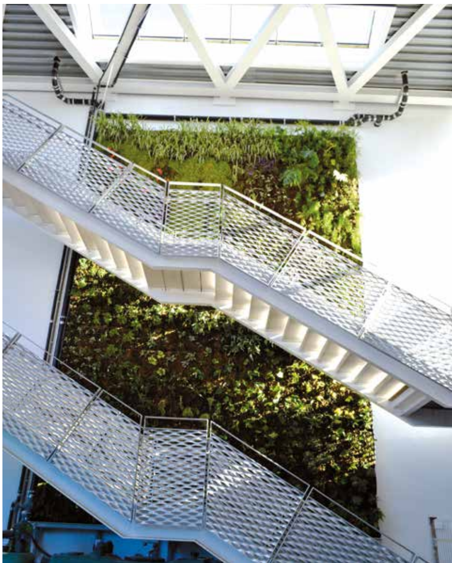
Un mur végétal de 50 m 2 a été intégré dans la Zone de Liaison Expérimentale (ZLE), non seulement pour la fonction décorative, mais pour étudier techniquement sa fonction hygrométrique.
